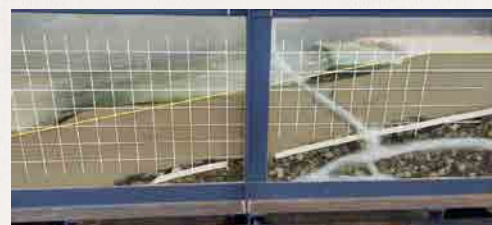
▲ ガラス造粒砂を使用した水槽実験中の様子
